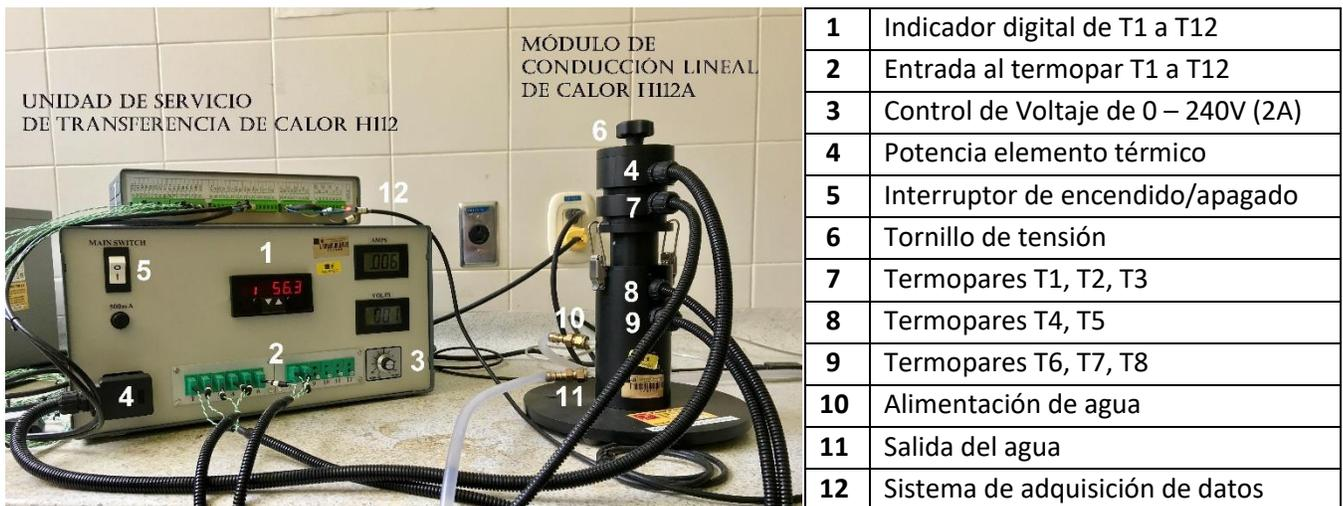
Figura 7. Equipo de conducción lineal de calor
